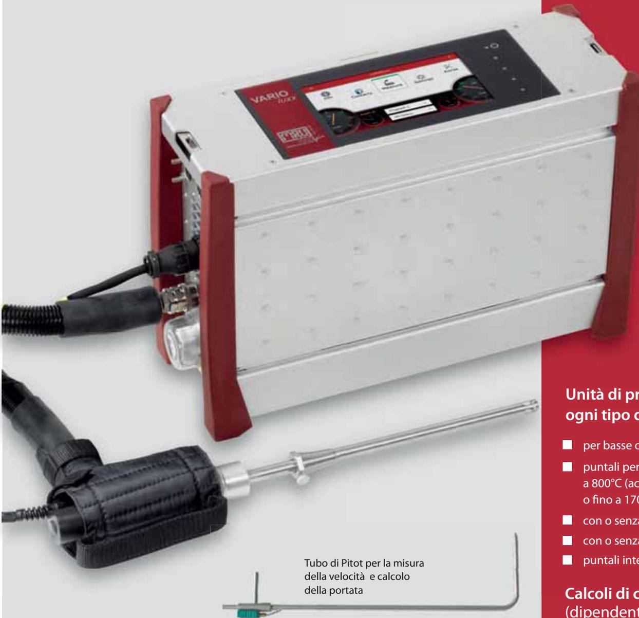
Tubo di Pitot per la misura della velocità e calcolo della portata
