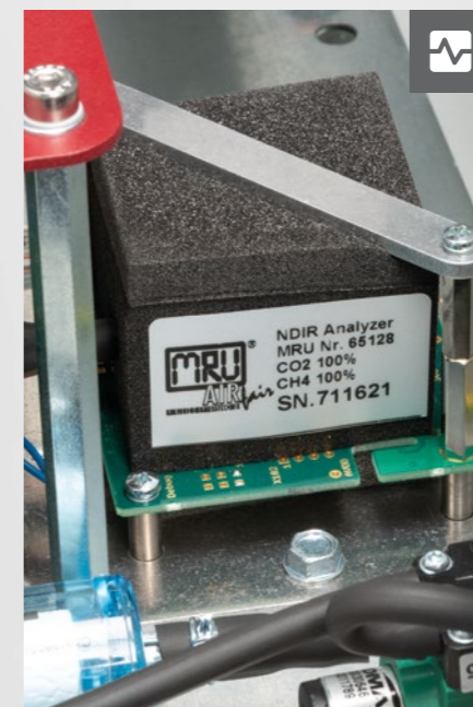
Sensore infrarossi NDIR doppio canale, per misure di CH 4 e CO 2
