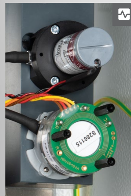
Sensori elettrochimici per O 2 , H 2 S espandibile con H 2
